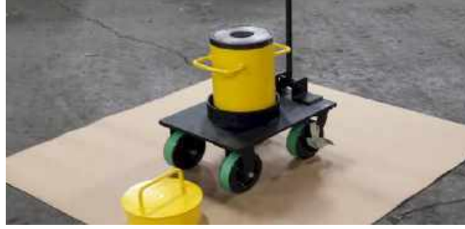
Şekil-17 Yüksek aktiviteli kaynaklar için taşıma ünitesi 1
