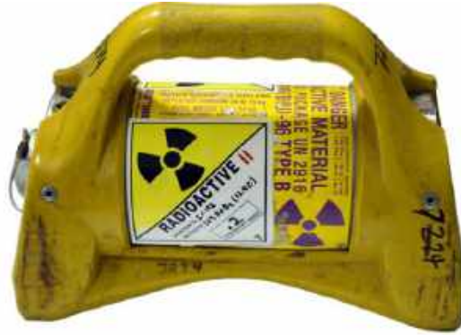
Şekil-18 Radyoaktif kaynağa ait bilgiler ve uygun etiket cihaz üzerinde
