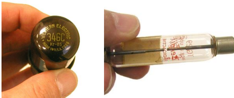
Resim 5. Radyoaktif madde içeren başlatıcı (starter) örnekleri
