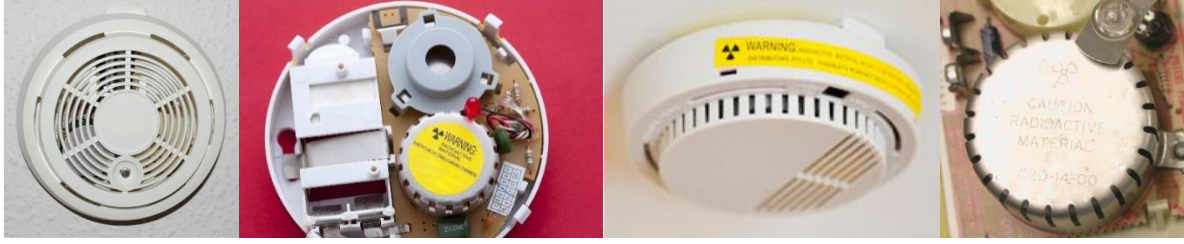
Resim 2. Radyoaktif madde içeren duman detektörleri
