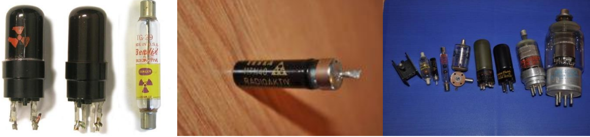
Resim 6. Radyoaktif madde içeren elektronik tüplere örnekler
