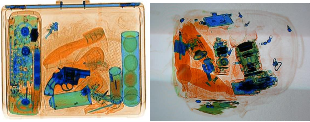
Şekil 2. X-ışını paket/bagaj kontrol cihazının içerisindeki eşyanın ekran görüntüsü
