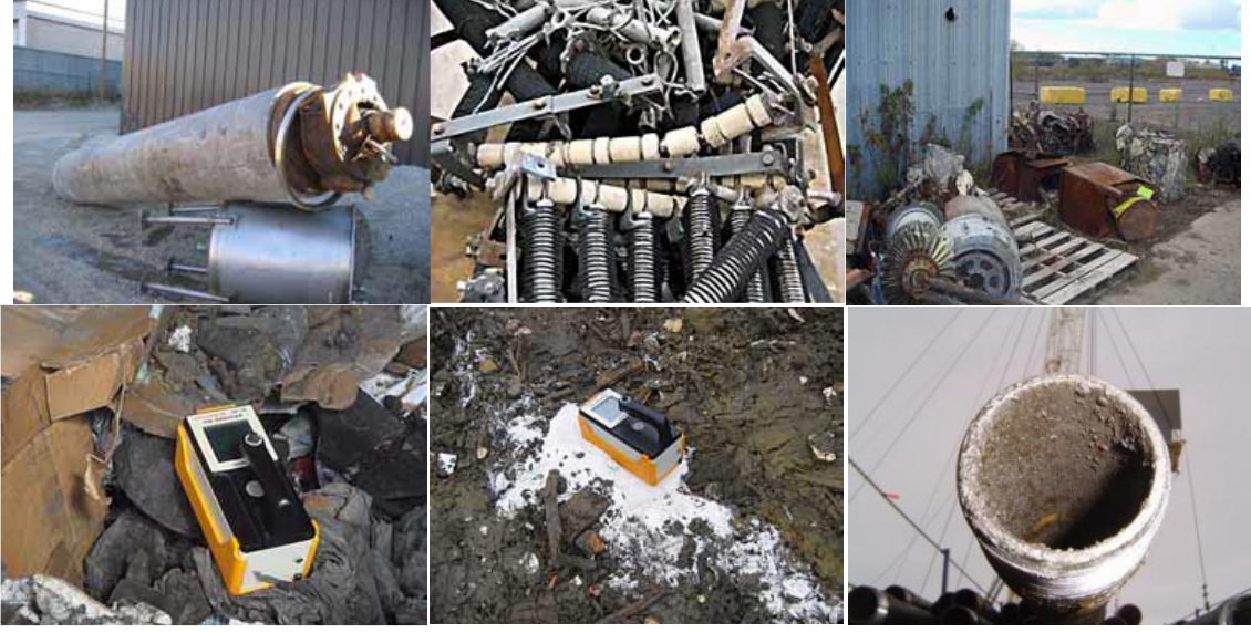
Resim 6: DORM (NORM) malzeme örnekleri
