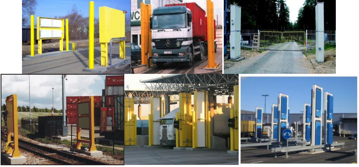
Resim 7: Sabit radyasyon ölçüm cihazları (sistemleri) örnekleri
