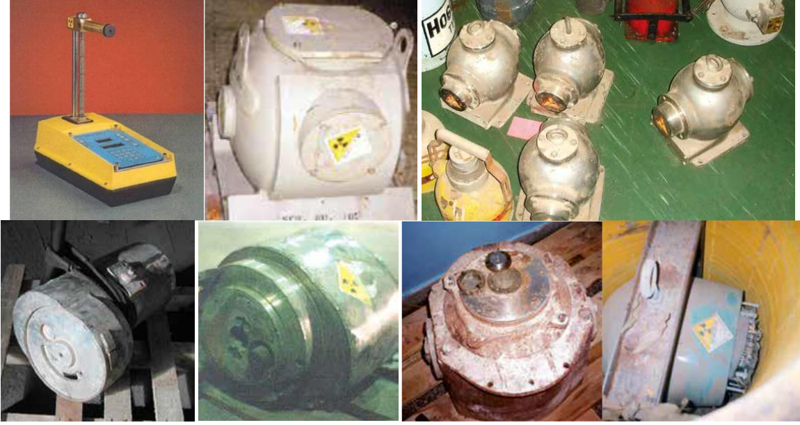
Resim 2: Radyoaktif kaynak içeren nükleer ölçüm cihazları örnekleri
