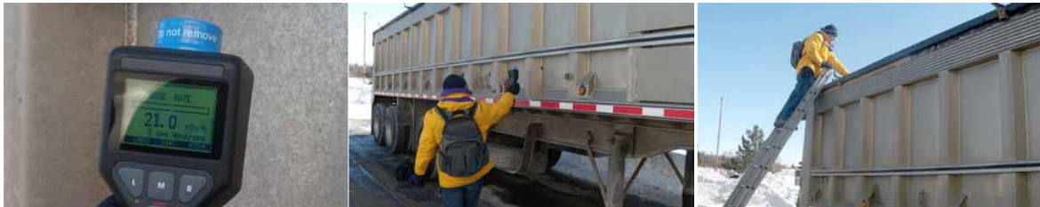
Resim 10: El dedektörü ile araç etrafında ve üzerinde radyasyon ölçümü
